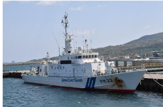
海上保安庁の巡視船「ふくえ」です。350 トン型で、アルミ合金製。ウォータージェット推進の高速型です。
